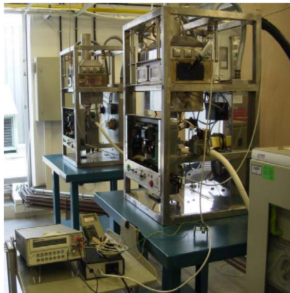
Fig.7. Prototipo de caldera estanca para medición de fotodetectores basados en nitruros (Ikerlan-Vitoria).
